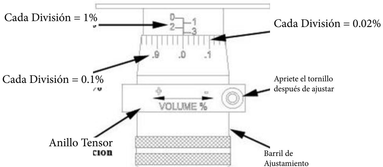
Para volúmenes distintos de 100 galones, la siguiente fórmula puede ser usada para calcular el porcentaje de regulación para aumentar o disminuir el volumen de prueba.
