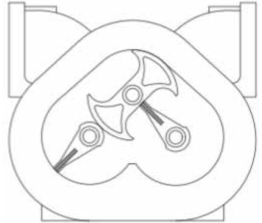
Los rotores en el medidor están diseñados para funcionar con tolerancias estrechas entre sí y la pared de la cámara de fluido. Se observan leves espacios entre los rotores y la pared de la cámara. Debido a esto, es importante que el medidor se aplique correctamente para el caudal y presión del funcionamiento del sistema.
